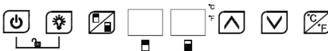
Control panel: ON/OFF · light · zone switch · upper- and lower-zone displays · up · down · °C/°F
