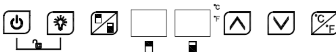
Panel de control: encendido/apagado · luz · cambio de zona · pantallas de zona superior e inferior · subir · bajar · °C/°F
