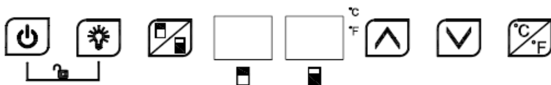
Pannello di controllo: on/off · luce · commutazione zona · display zona superiore e inferiore · su · giù · °C/°F
