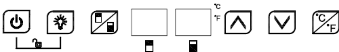
Kontrollpanel: PÅ/AV · belysning · zonväxling · displayer för övre och nedre zon · upp · ner · °C/°F
