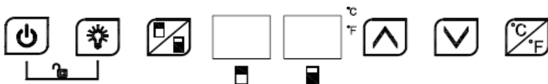
Panneau de commande : marche/arrêt · éclairage · sélection de zone · écrans des zones supérieure et inférieure · haut · bas · °C/°F
